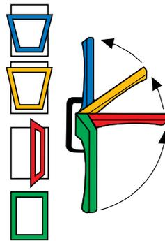
Für den Fall, dass die Fenster aufgrund der Lage, durch Wind oder Sog in der Kippstellung zuschlagen bzw. in der Drehstellung auf- oder zufallen, stehen spezielle Zubehörteile zur Verfügung, die dies verhindern.
