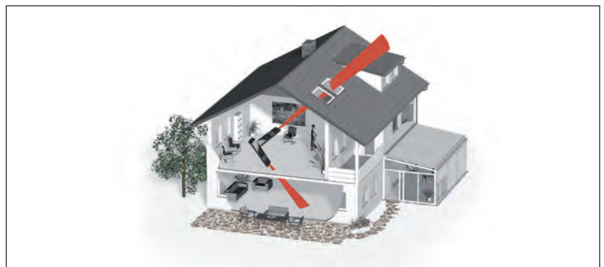
Abb. 29 Ausbreitung von Funkwellen in Gebäuden
